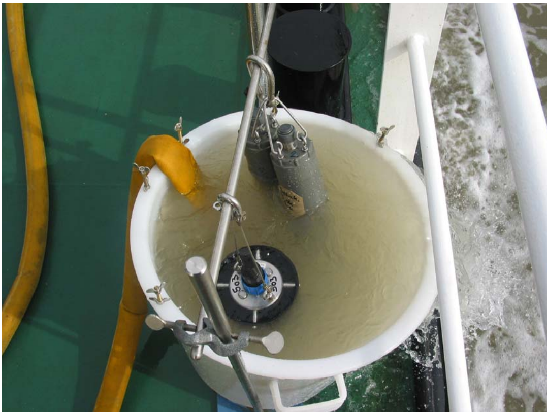
Abb. 1-1: Chlorophyll- und Multiparameter-Messsonden im Durchflussbehälter mit Zulauf (gelber Schlauch) und Überlauf auf dem Messschiff Zenit am 03.05.2005.
