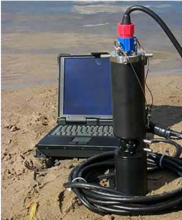
Abb. 3.2.3-1: Chlorophyllfluoreszenz-Sonde bbe FluoroProbe (Fa. Moldaenke) mit Kabel und Computer für die Übertragung und Auswertung der Messdaten
