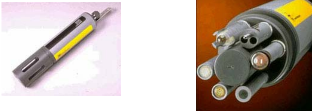
Abb. 3.2.2-1: Gesamtansicht und Sondenkopf der Multiparametersonde YSI 6920
