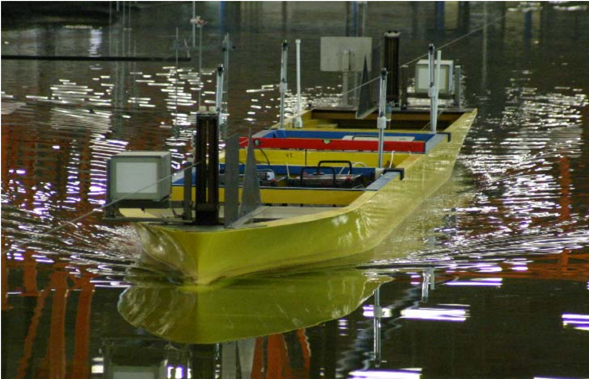
Bild 10: Containerschiff PPM40 bei Fahrt im hydraulischen Modell
